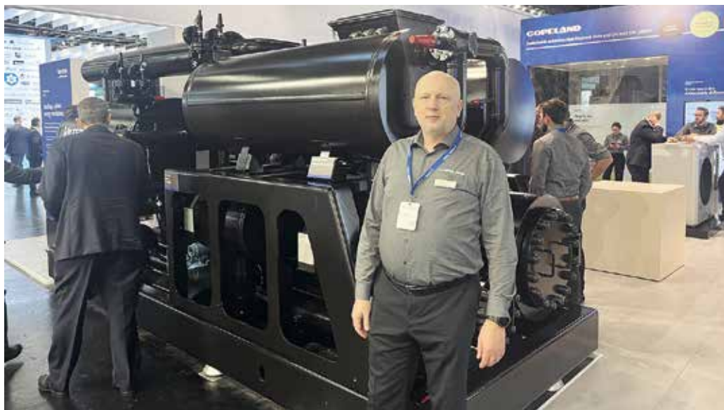
Obr. 2: Ing. Pavel Sudek hrdě předvádí vysokoteplotní průmyslové čpavkové tepelné čerpadlo firmy Copeland o výkonu až 5 MW
