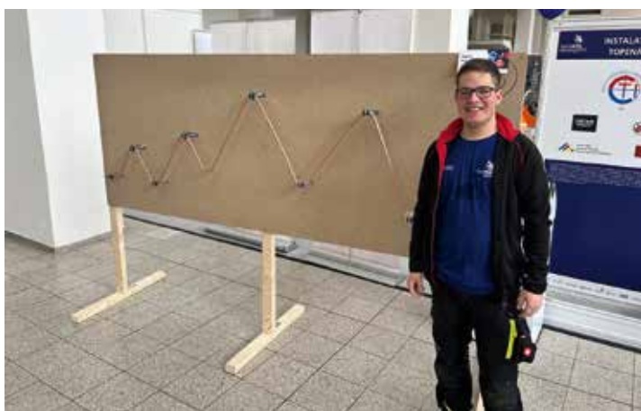
Obr. 3: takto si se zadáním poradili soutěžící: hodnotila se kvalita provedení, kvalita ohybů, dodržení rozměrů a dodržení časového limitu
