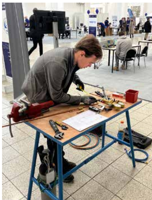
Obr. 4: druhá část – sestavování Cu potrubí (viz. schéma výše). Soutěžící měli v časovém limitu vyhotovit část potrubí s několika šroubovými a pájenými spoji, napojením komponenty, ohyby a přechody z různých průměrů trubek.
