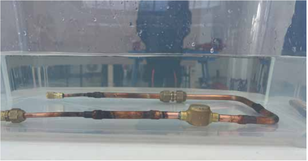
Obr. 5: těsnost spojů se po natlakování kontrolovala ve vodní lázni
