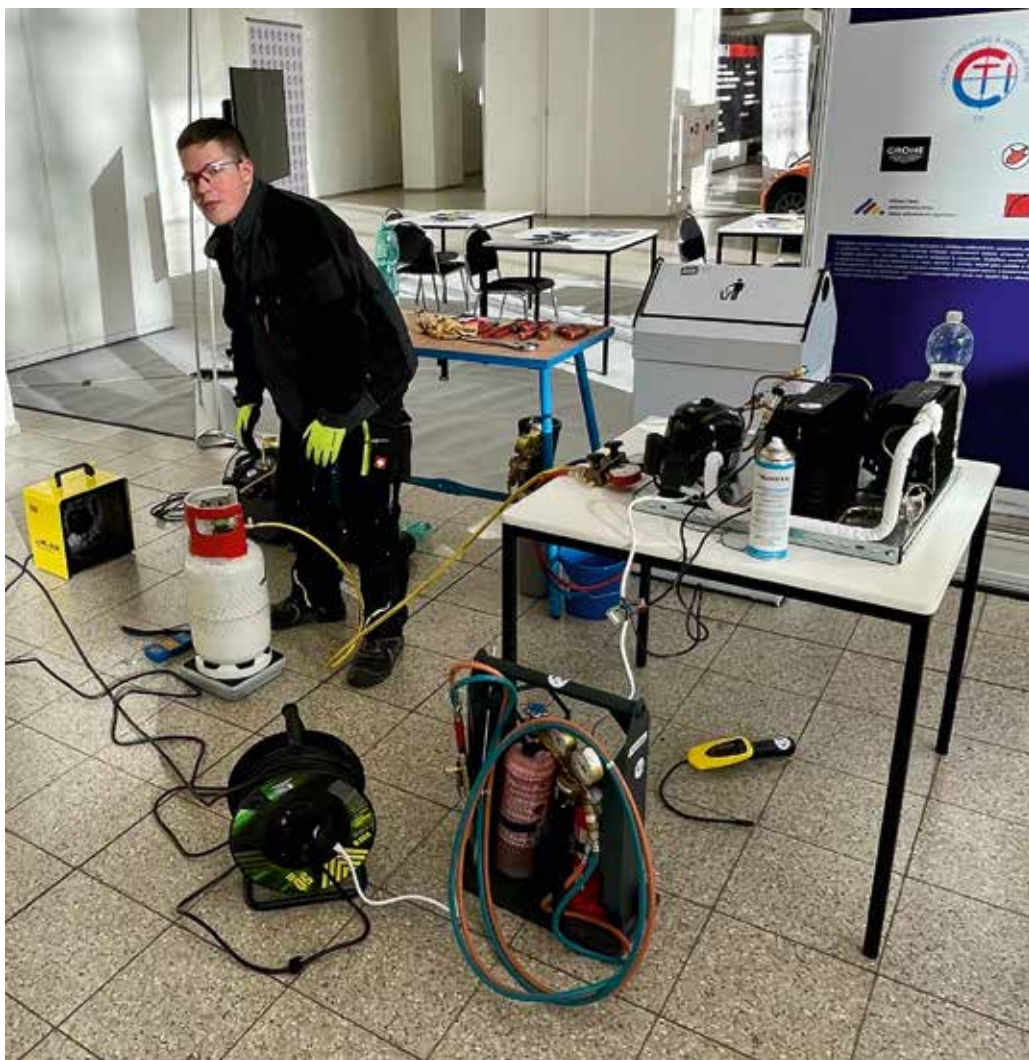
Obr. 12: na této fotce je vidět, že během práce s propanem, kdy probíhá plnění zařízení z tlakové lahve, má soutěžící zapnutý servisní ventilátor a pod pracovním stolem má zapnutý detektor úniku, který signalizuje případnou nebezpečnou koncentraci hořlavého plynu. Samozřejmostí jsou pracovní rukavice a ochranné brýle. Dodržování zásad bezpečnosti práce a nošení osobních ochranných pomůcek bylo po celou dobu soutěže pečlivě sledováno a za každé porušení byly strhávány body.
